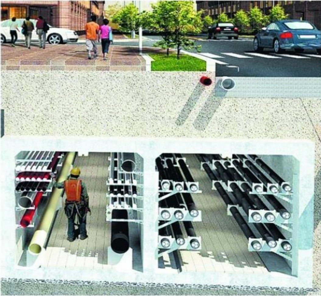
图 4.3-1 综合管廊断面示意图
